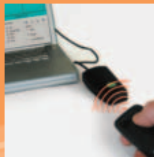
Trasmissione dei dati raccolti al Software dedicato installato su personal computer.
